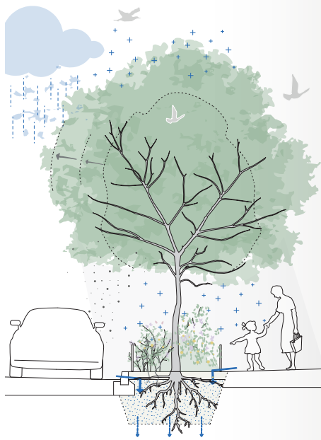
ARBO est une fosse à impluvium conçue par apaar — Atelier paysage et architecture (Genève) — pour faciliter l'introduction de l'arbre en milieu urbain, partout où sa plantation est possible. Une solution rapide, souple et réversible pour végétaliser la ville ponctuellement et améliorer le confort urbain. Dessin: arbo@apaar
