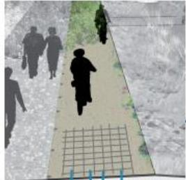
Les structures filtrantes permettent aux sols de reprendre vie sans les asphalter. La compensation de l'imperméabilisation permet de réduire les volumes de rétention, tout en permettant de protéger la ressource en eau par recharge de nappes phréatiques.
