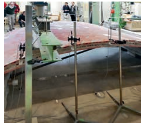
Fig. 3 — Tests comparatifs de trois voûtes de 4 m de portée, respectivement réalisées en Ecorasillas (briques en terre crue d'excavation, 2 cm d'épaisseur) selon la technique catalane, en shot-earth et en briques de rasillas allégées en terre cuite, également selon la technique catalane
