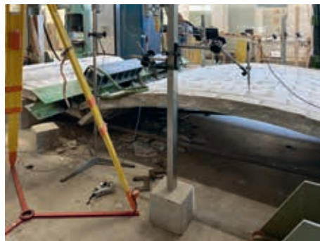
Fig. 3 — Tests comparatifs de trois voûtes de 4 m de portée, respectivement réalisées en Ecorasillas (briques en terre crue d'excavation, 2 cm d'épaisseur) selon la technique catalane, en shot-earth et en briques de rasillas allégées en terre cuite, également selon la technique catalane
